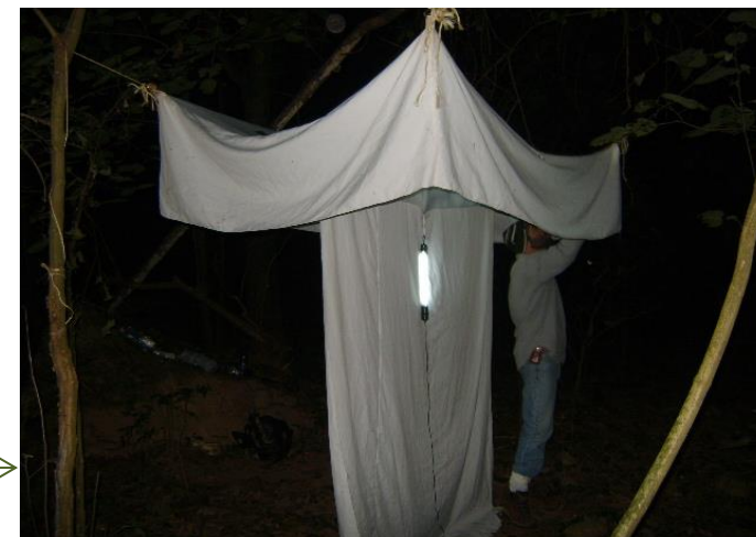
Armadilha luminosa modelo “Shannon” utilizada para coletas noturnas de insetos.
