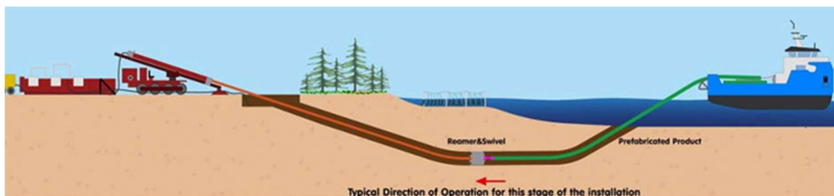
Figura 4-7: Ilustração Típicas de instalação de dutos.
