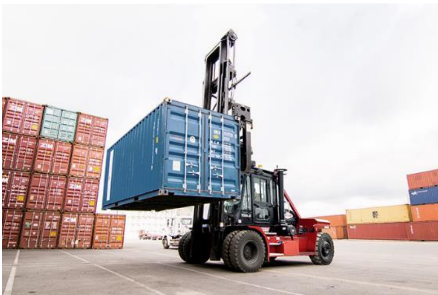
Figura 4-130: Operação com Empty Handlers . Fonte: Feyter Ibéria, 2024.
