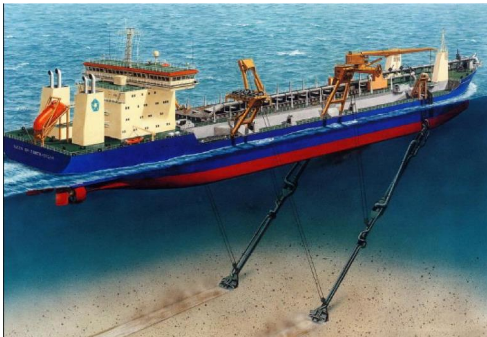
Figura 4-29: Ilustração de operação da draga hopper Fonte: AllOnda, 2018
