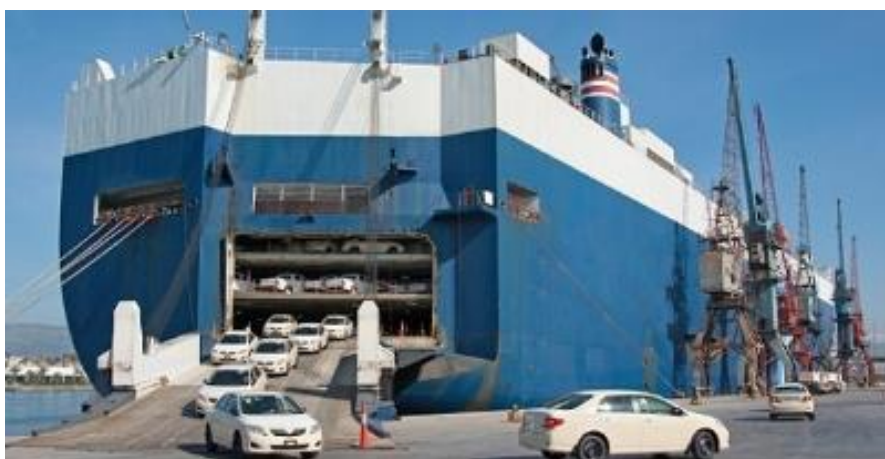
Figura 4-147: Exemplo de desembarque de navio Ro-Ro. Fonte: TSL Logistics Solutions, 2021.
