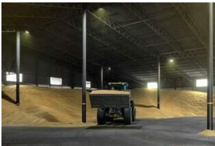
Figura 4-189: Exemplo de trator para manipulação de granéis sólidos no armazém. Fonte: Campo Grande News, 2023.
