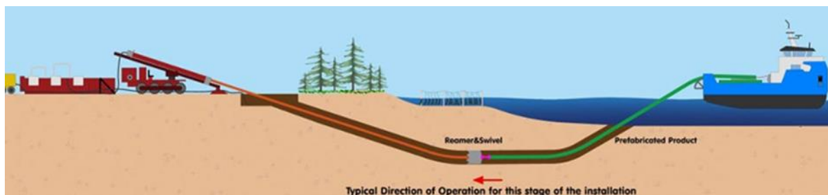
Figura 4-7: Ilustração Típicas de instalação de dutos.
