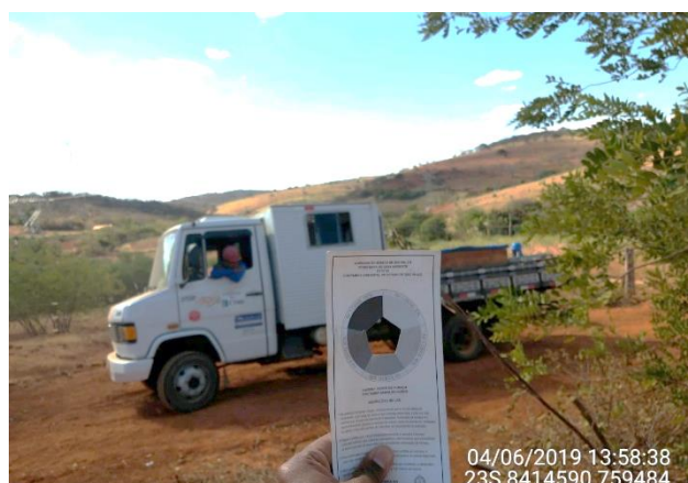
Foto 3-9: Monitoramento de fumaça preta (escala de Ringelmann). Fonte: Acervo Dossel, 2019.
