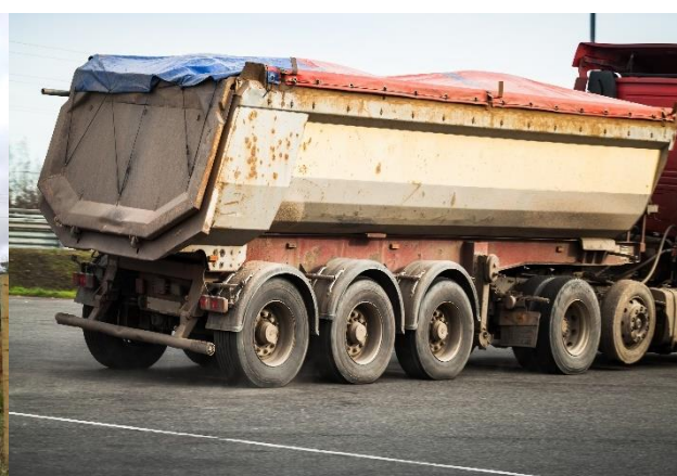
Foto 3-6: Exemplo de caminhão basculante com cobertura por lona, para transporte de agregados.
