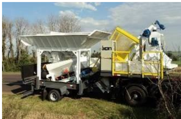
Figura 15: Exemplo da Usina de Concreto Móvel.
