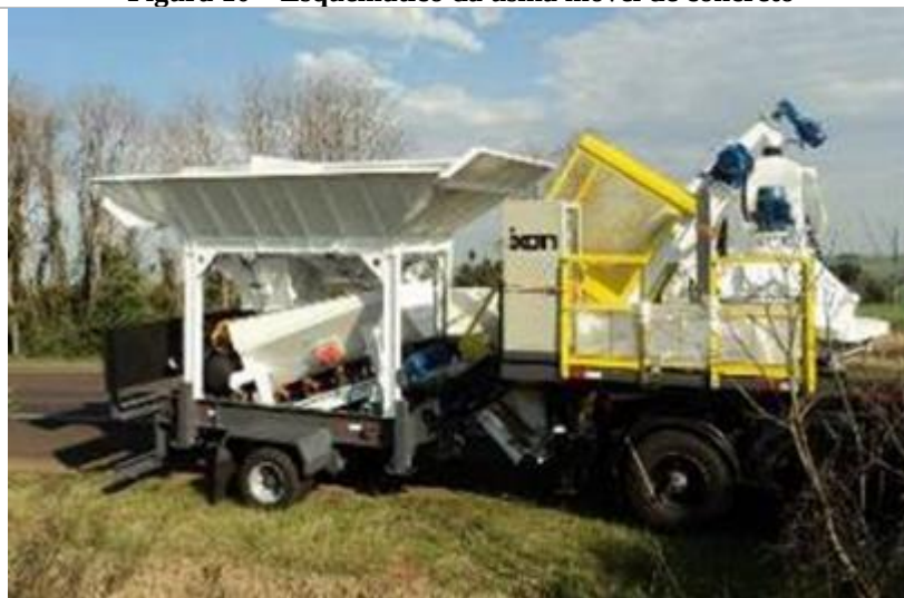
Figura 11 – Exemplo de usina móvel de concreto
