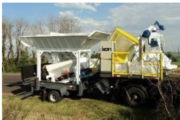
Figura 15: Exemplo da Usina de Concreto Móvel.
