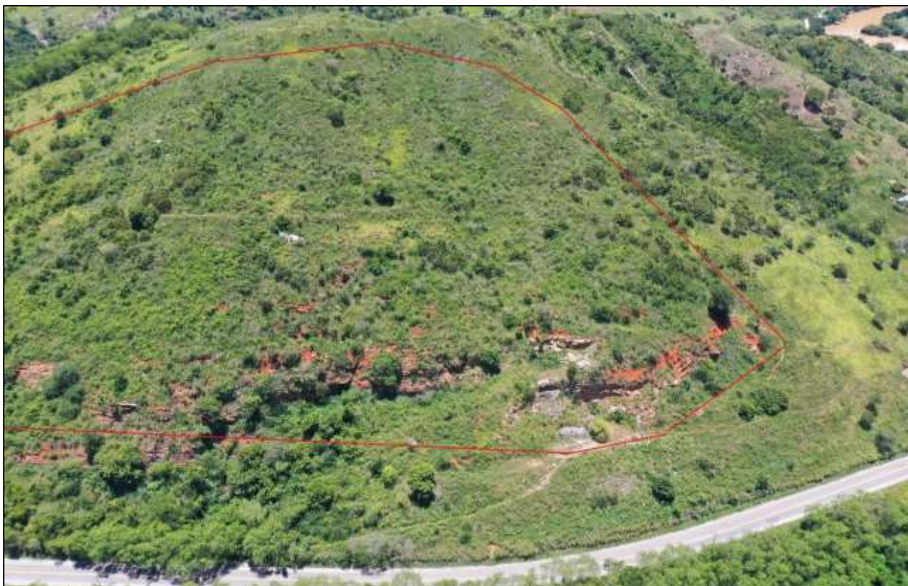
Figura 1.11.5 -1: Vista do local (aerofotografia), panorama sobre frente de lavra inicial da Cava 5 parcialmente aberta, com a poligonal L1 em vermelho e, ao sul, a Rodovia ES 488.
