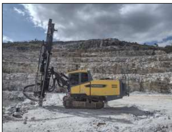
Figura 1.10.2.1.2-1: Equipamento utilizado para perfurar as bancadas de mineração.
