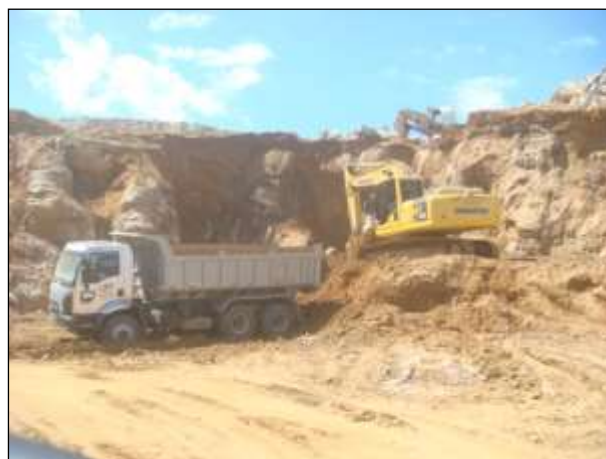
Figura 1.10.2.1.1 -1: Equipamentos executando o decapeamento realizado na Cava 1, 2013.
