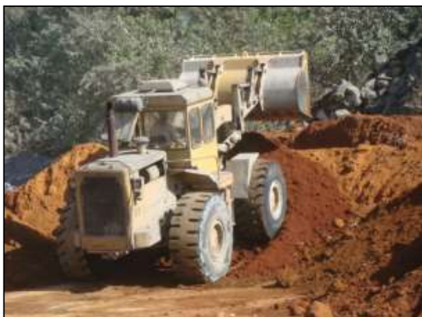
Figura 1.10.2.1.1 -1: Equipamentos executando o decapeamento realizado na Cava 1, 2013.
