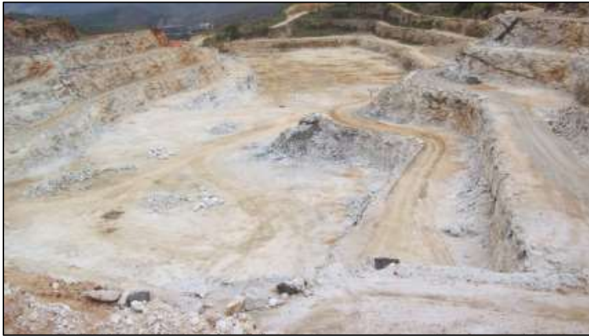
Figura 2.2.3-6: Vista geral da área de lavra do calcário atual (Cava 1). Notar a exposição do mármore após o decapeamento (Ponto N2).
