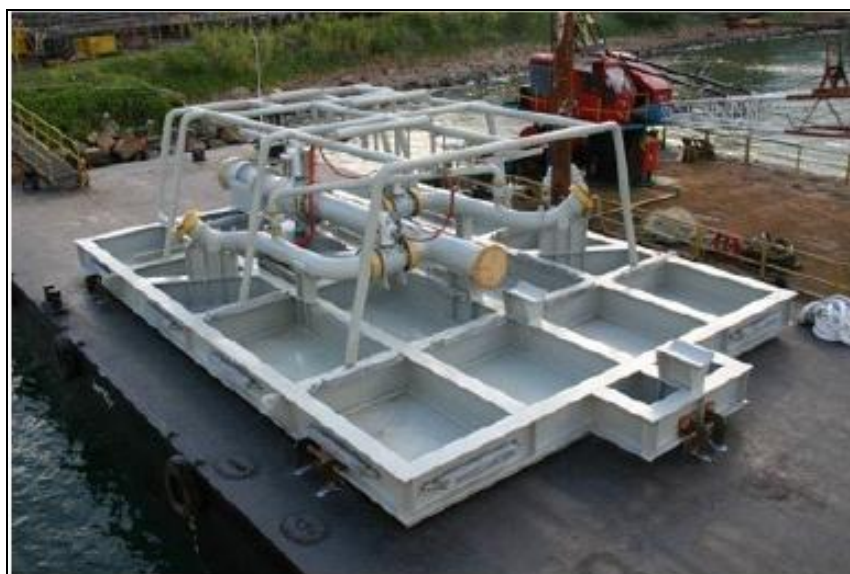
Figura 3-11: Ilustração de um conjunto de válvulas PLEM ( Pipe Line End Manifold ).
