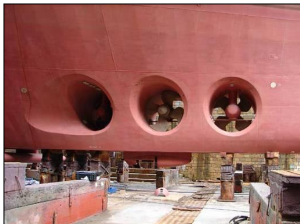
Figura 3-22: Tipos de sistemas de propulsores utilizados no DP
