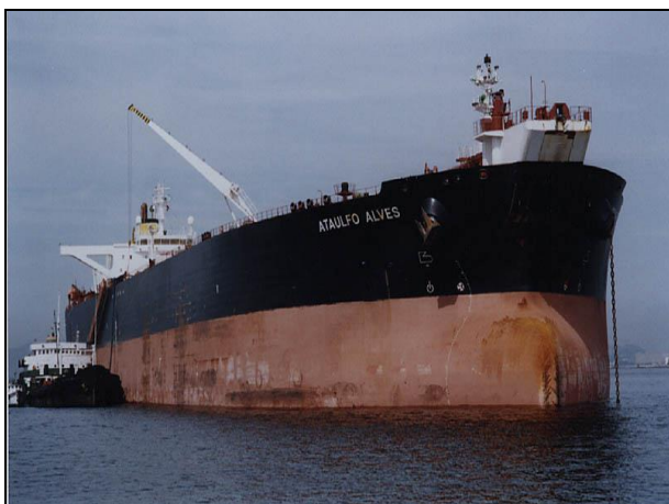
Figura 3-2: Navio Tanque Aliviador DP Classe Suezmax. Fonte: naviosbrasileros.com.br
