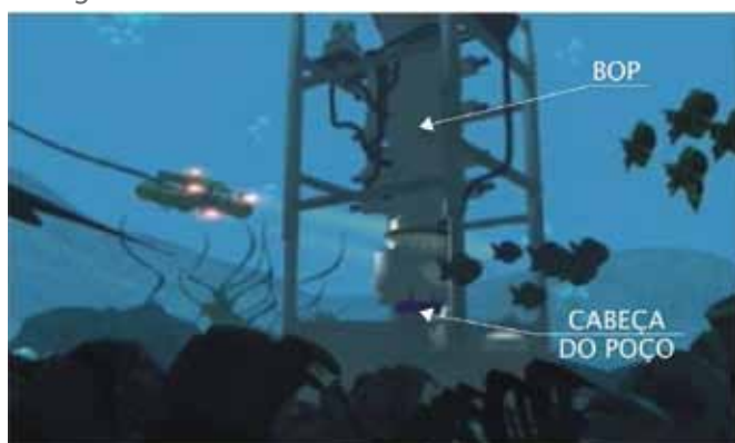
BOP instalado no fundo do mar
