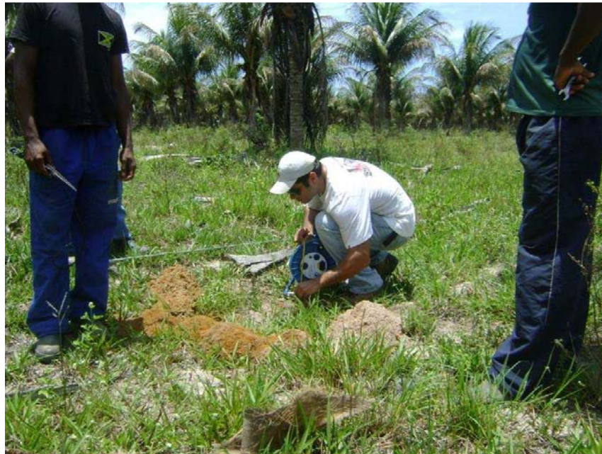
Figura 28 - Detalhe para medição do nível de água
