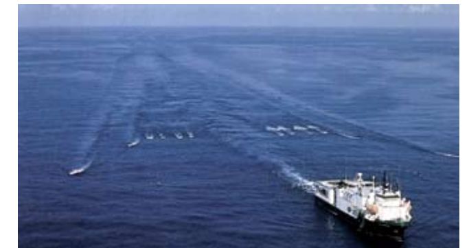
Navio sísmico arrastando os cabos sísmográficos e hidrofones
