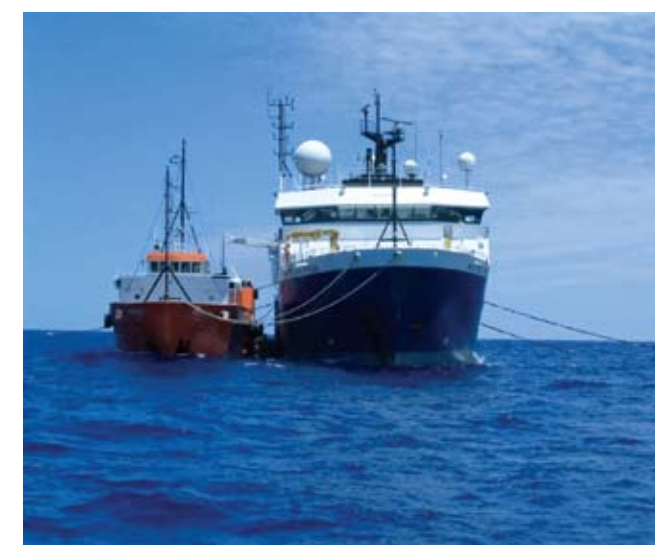
Barco de apoio e navio sísmico, emparelhados em alto-mar, para realizar o processo de abastecimento
