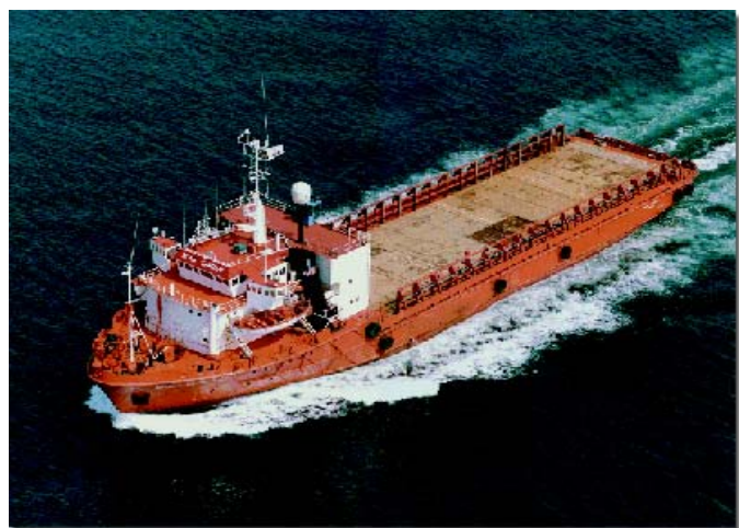
Figura 2-8 - Embarcação Pipe Carrier que transporta dutos para a BGL-1
