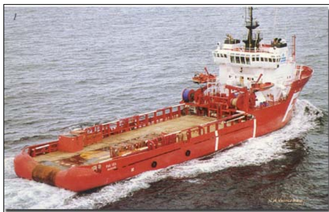
Figura 2-9- Embarcação tipo AHTS para movimentação das âncoras da BGL-1.
