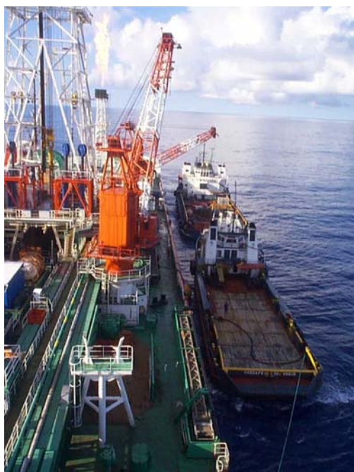
Figura 2-13 - Ilustração de um barco de apoio junto a um FPSO
