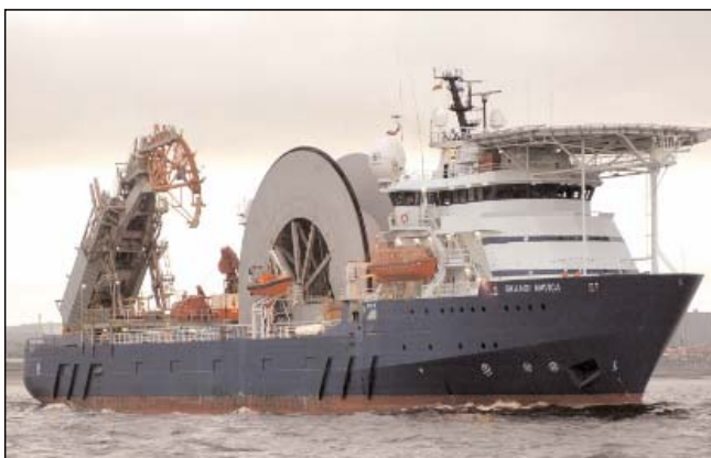
Figura 2-10 - Embarcação Skandi Navica a ser utilizada para lançamento em águas profundas
