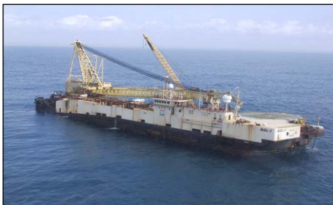
Figura 2-7 - Balsa Guindaste de Lançamento que irá lançar o gasoduto/GLPduto em águas rasas
