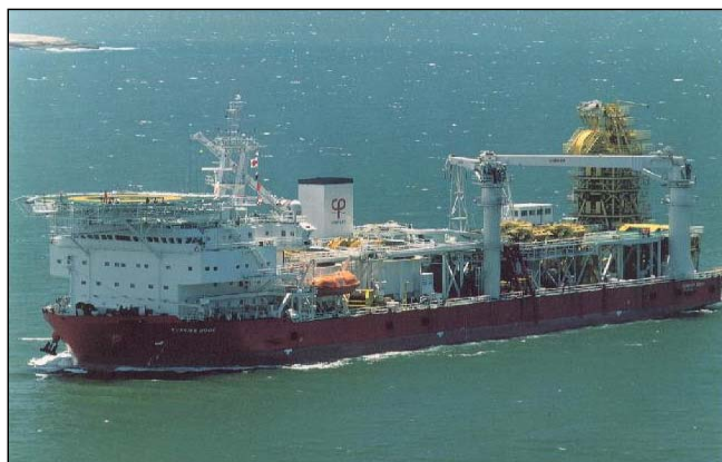
Figura 2-12- Embarcação Sunrise 2000 que irá realizar os lançamentos das linhas de produção.
