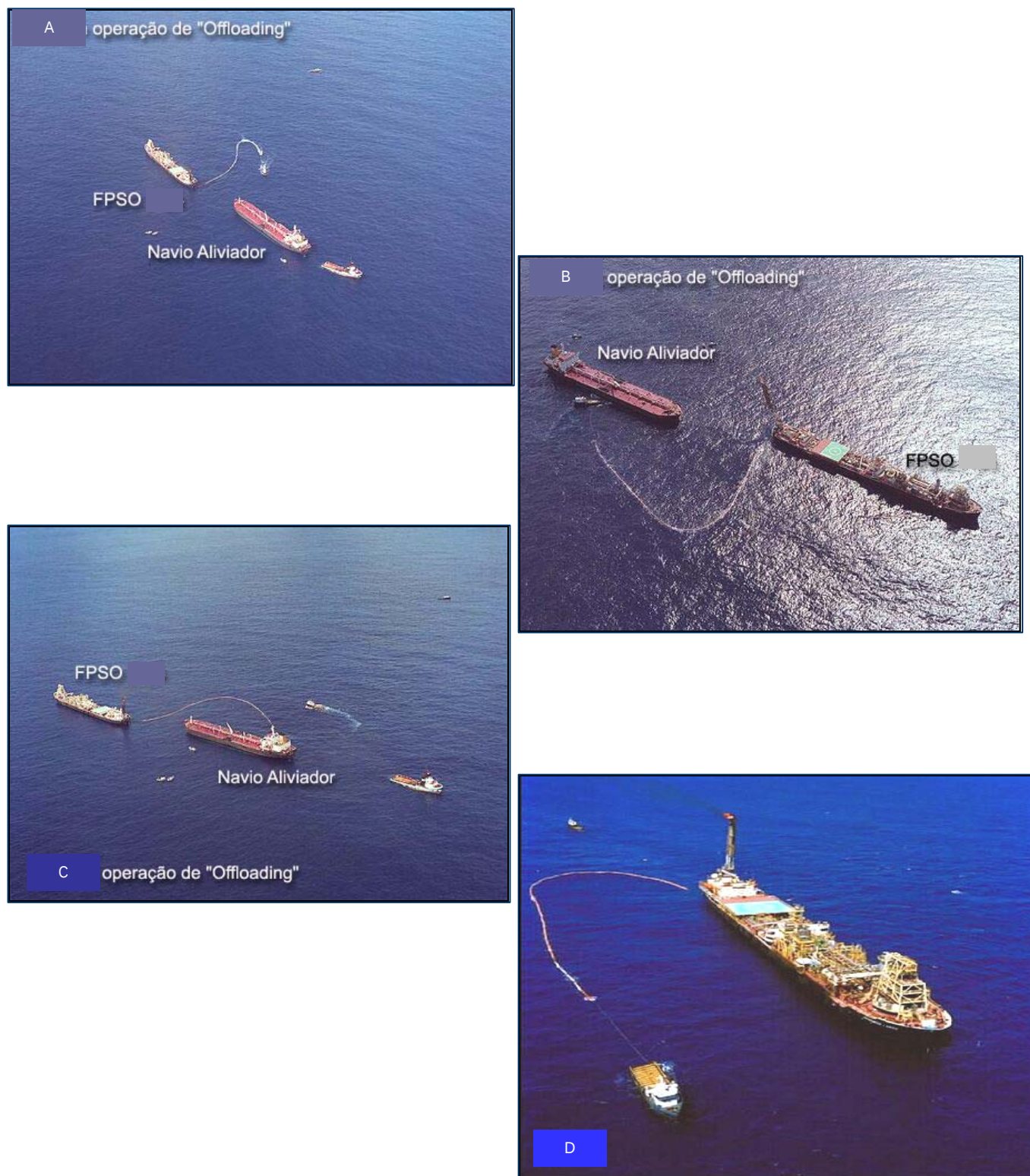
Figura 2-3 - Esquema típico mostrando o processo de transferência de petróleo entre uma unidade FPSO e um navio aliviador. A) Barco de apoio estende o mangote de transferência da FPSO até o aliviador; B) Barco de apoio levando o mangote de transferência para o navio aliviador; C) Operação de transferência (offloading) acompanhada por barcos de apoio; D) Barco de apoio retorna com mangote de transferência para a FPSO.
