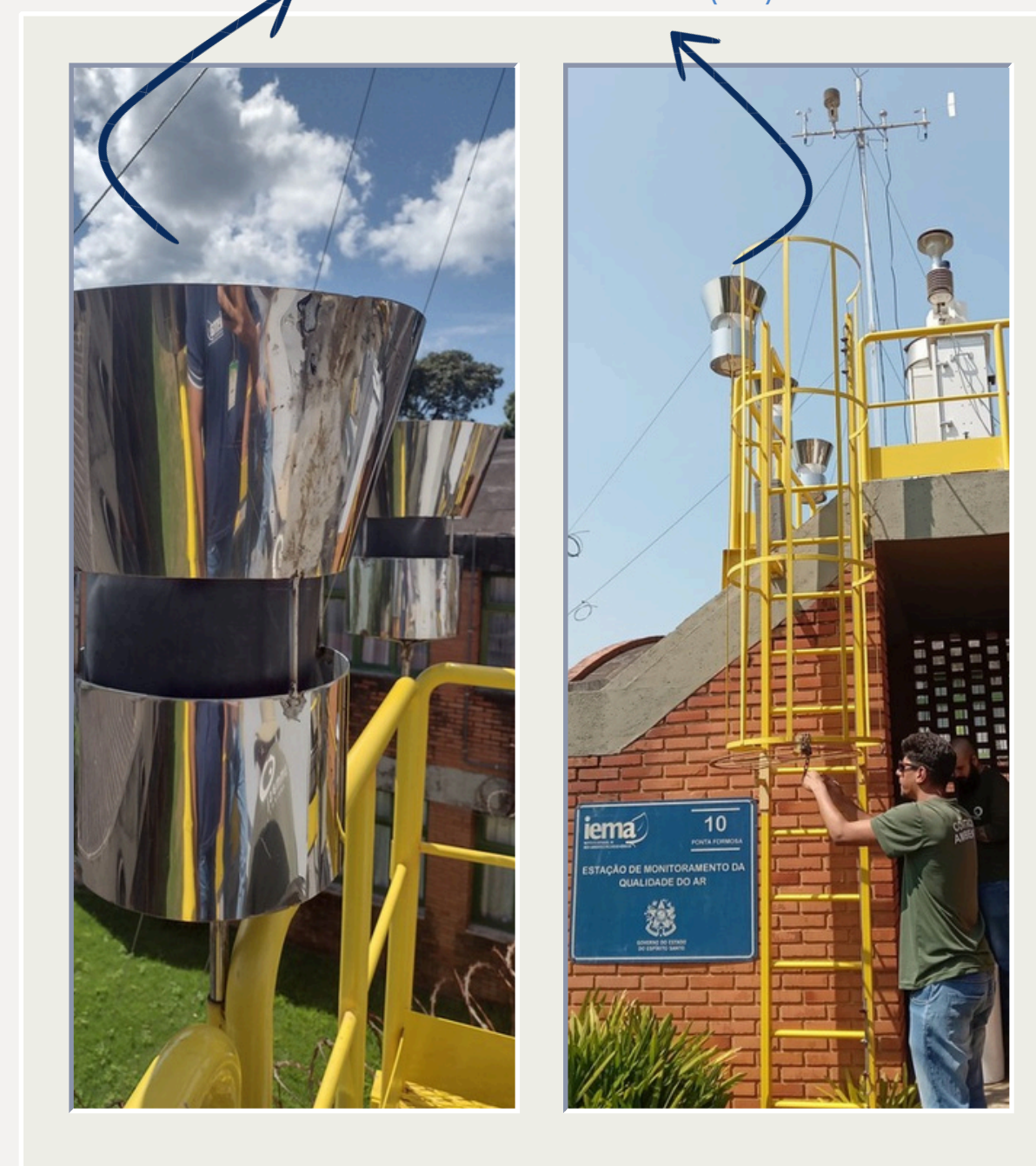
Recipiente coletor de Partícula Sedimentável (PS)
