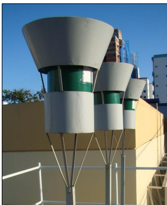
Figura 7: Aparato para coleta de partículas sedimentáveis.
