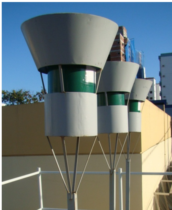
Figura 4: Aparato para coleta de partículas sedimentáveis.
