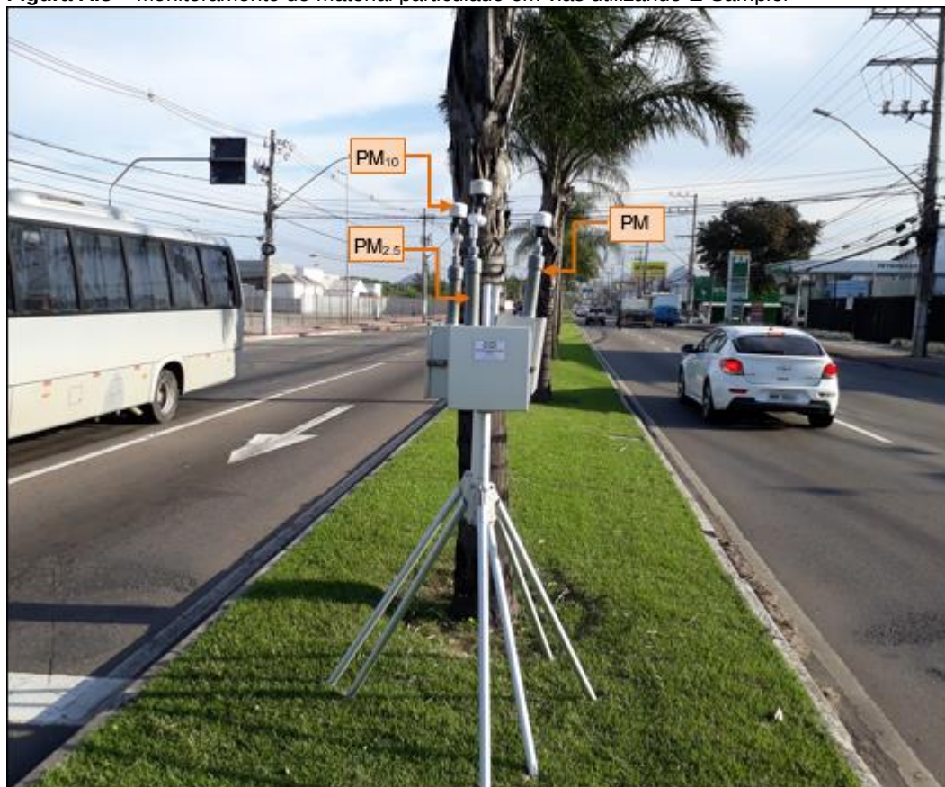
Figura A.8 – Monitoramento de material particulado em vias utilizando E-Sampler
