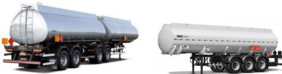
Figura 12: Imagem ilustrativa de tipos de caminhões-tanques a serem utilizados. À esquerda é ilustrado um caminhão-tanque do tipo bitrem e à direita um do tipo vanderleia.
