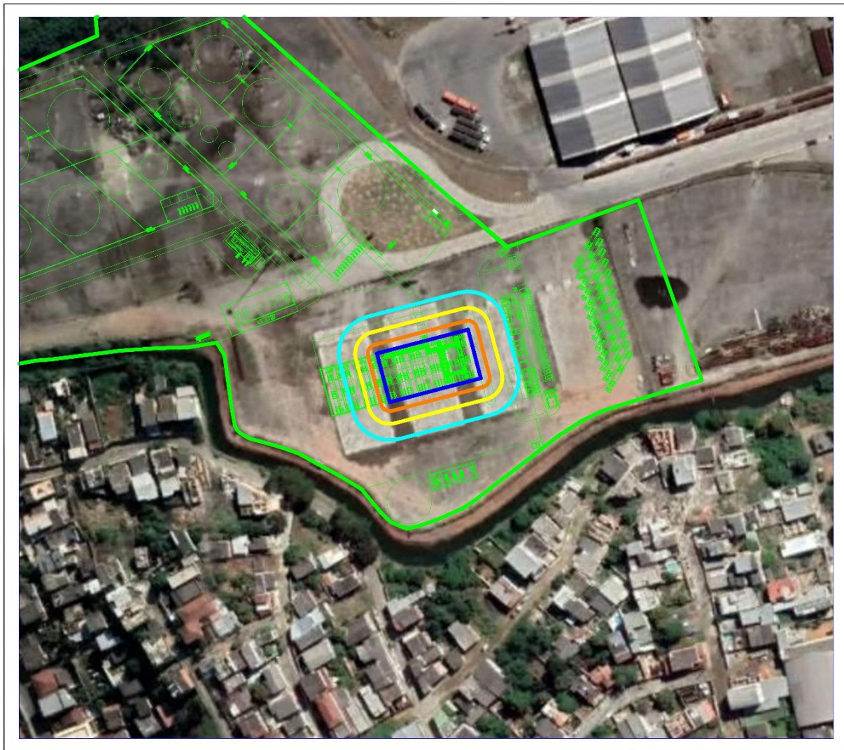
Figura 21: Mapa de vulnerabilidade para o combustível etanol na plataforma 1. Legenda: Curva de 1% letalidade em cor azul claro; bacia de contenção em cor azul escuro.
