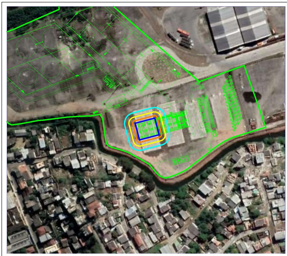
Figura 22: Mapa de vulnerabilidade para o combustível etanol na plataforma 2. Legenda: Curva de 1% letalidade em cor azul claro; bacia de contenção em cor azul escuro.
