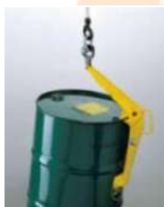
Figura 14: modelo de garra prática utilizada para içamento de tambor
