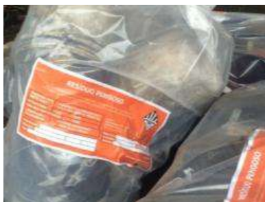
Figura 19: Baldes de graxa vazios acondicionados em saco do tipo polydomus dentro da contenção
