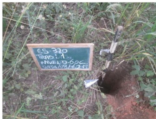
Imagem 7.1.1-2 – Tradagem 01 escavada até 60 cm de profundidade.
