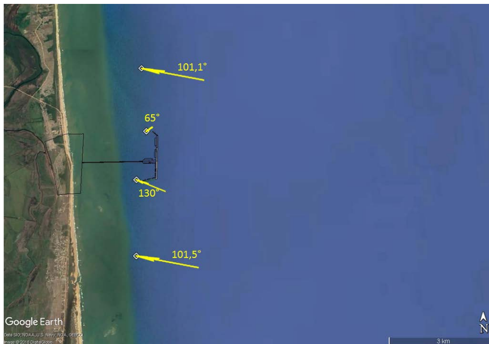
Figura 51 - Direção e magnitude do fluxo médio de energia analisado para os 4 pontos (P1 a P4 da esquerda para a direita) ao longo da Praia da Barra Seca para o layout 1, offshore.
