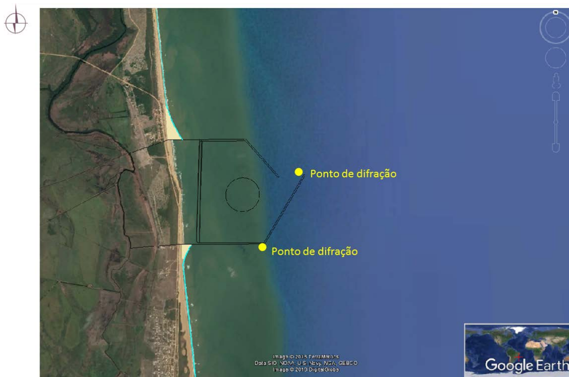
Figura 53 - Forma em planta de equilíbrio da Praia da Barra Seca após a construção do layout 1, offshore, e a localização dos Pontos de Difração responsáveis pela dinâmica costeira.
