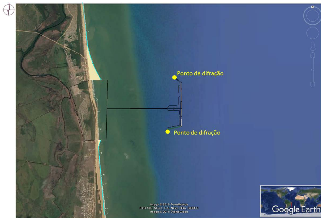
Figura 53 - Forma em planta de equilíbrio da Praia da Barra Seca após a construção do layout 1, offshore, e a localização dos Pontos de Difração responsáveis pela dinâmica costeira.
