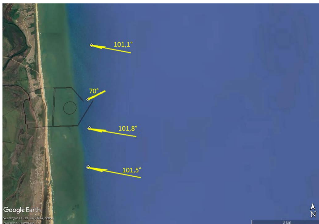
Figura 52 - Direção e magnitude do fluxo médio de energia analisado para os 4 pontos (P1 a P4 da esquerda para a direita) ao longo da Praia da Barra Seca para o layout 2, onshore.
