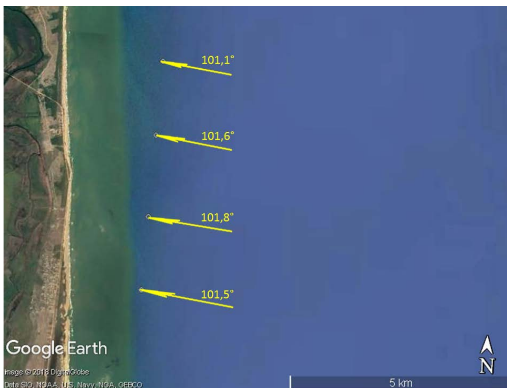
Figura 50- Direção e magnitude do fluxo médio de energia analisado para os 4 pontos (P1 a P4 da esquerda para a direita) ao longo da Praia da Barra Seca para a situação sem empreendimento.
