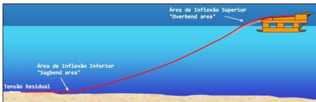
Figura 4.2-8: Método de lançamento S-Lay.
