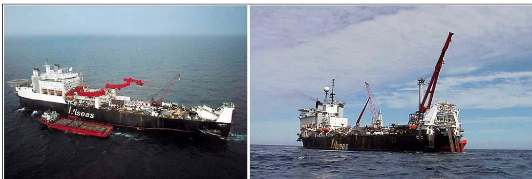
Figura 4.2-9: Embarcação Típica de utilização do método S-Lay do tipo Navio.
