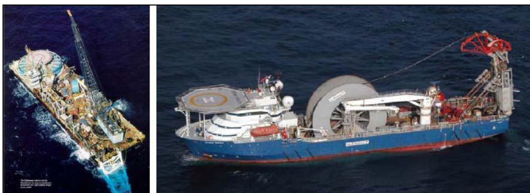
Figura 4.2-7: Embarcações típicas - Balsa (rampa tipo S-Lay) e Navio (rampa Vertical).
