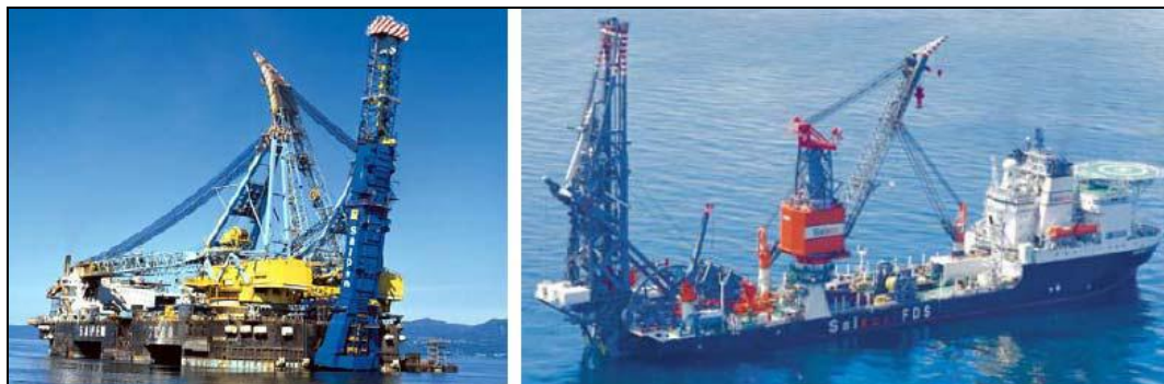
Figura 4.2-4: Embarcações típicas, tipo Semi-Sub e Navio.
