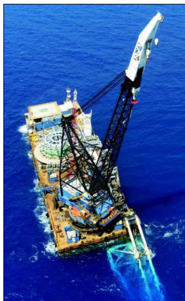
Figura 4.2-10: Embarcação Típica de utilização do método S-Lay do tipo Balsa.
