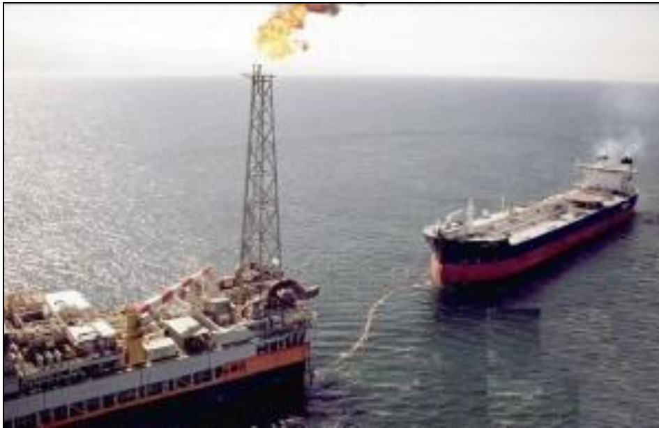
Figura 2.5.1.2-3: FPSO descarregando óleo para um Aliviador DP. Fonte: Petrobras.
