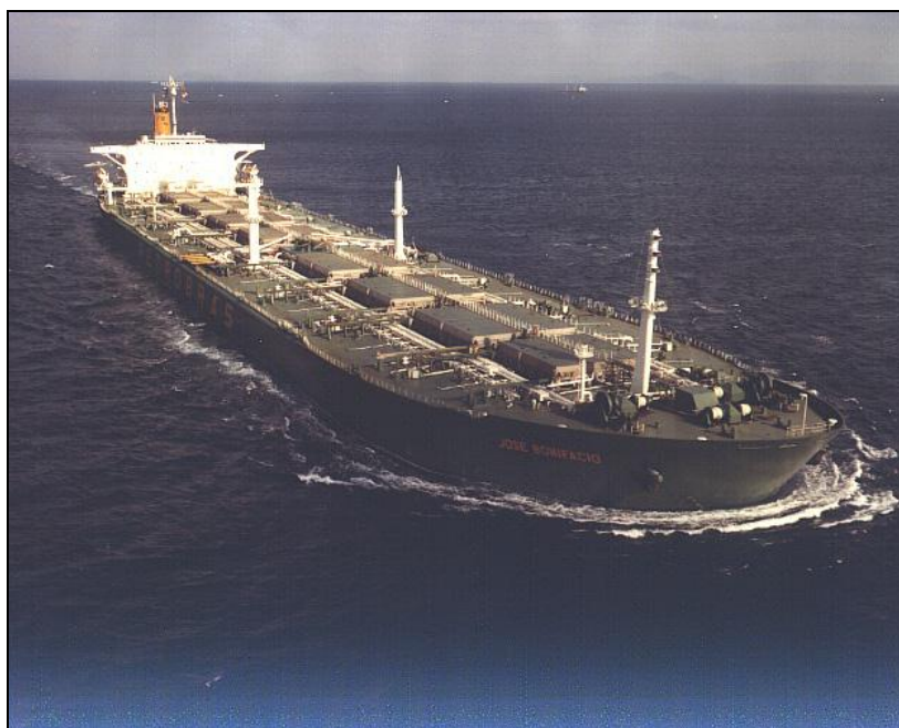
Figura 2.5.1.2-4: VLCC – José Bonifácio convertido para P-35. Fonte: Petrobras.
