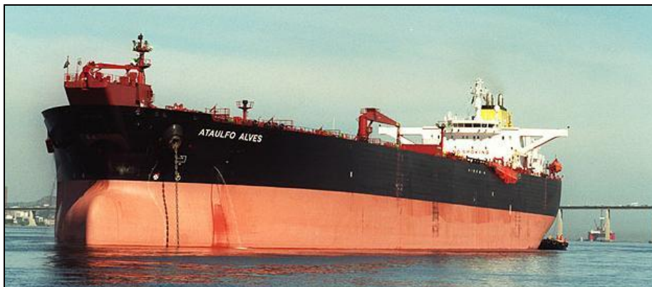
Figura 2.5.1.2-1: Navio Tanque Aliviador DP – Ataulfo Alves (classe Suezmax). Fonte: Transpetro.
