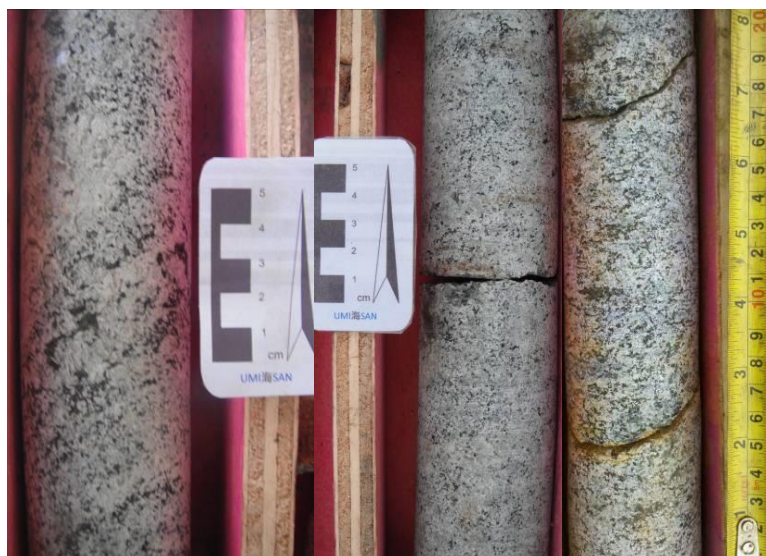
Figura 3-11: Testemunhos recuperados de Granito.
