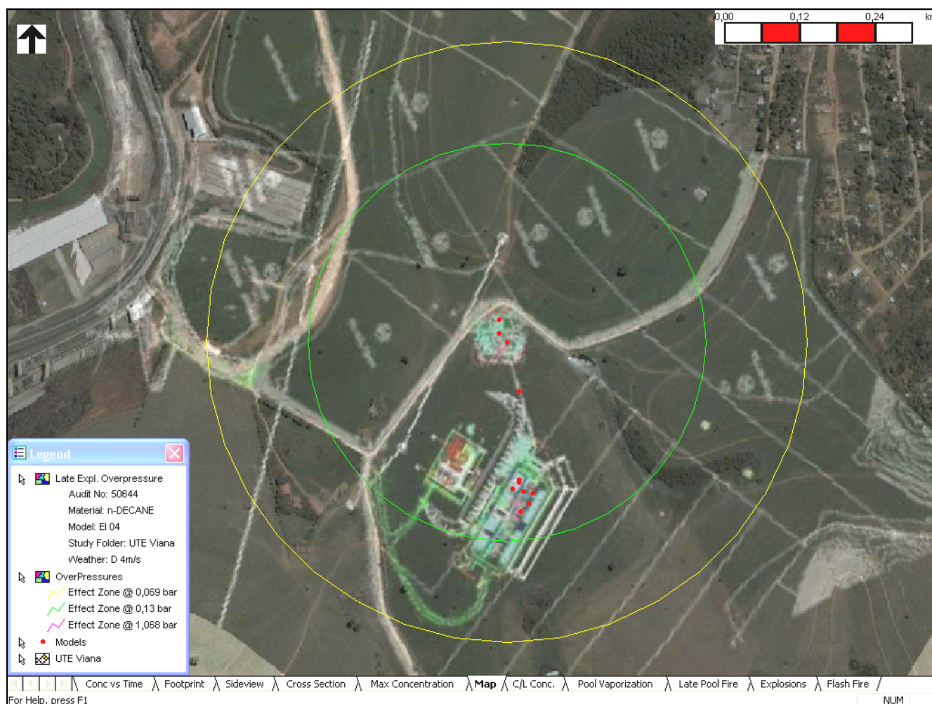
Figura 5.4.4-3: Área Vulnerável a Explosão de nuvem não confinada (EI – 04 = 506,8 m para 0.069 bar e 345,8 m para 0.13 bar))
