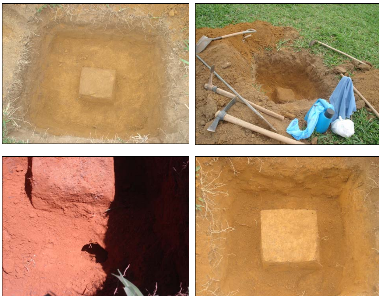
Figuras 4.1.6-1, 4.1.6-2, 4.1.6-3 e 4.1.6-4: Coleta de amostras indeformadas de solos na área de estudo para determinação de permeabilidade e coesão em laboratório.
