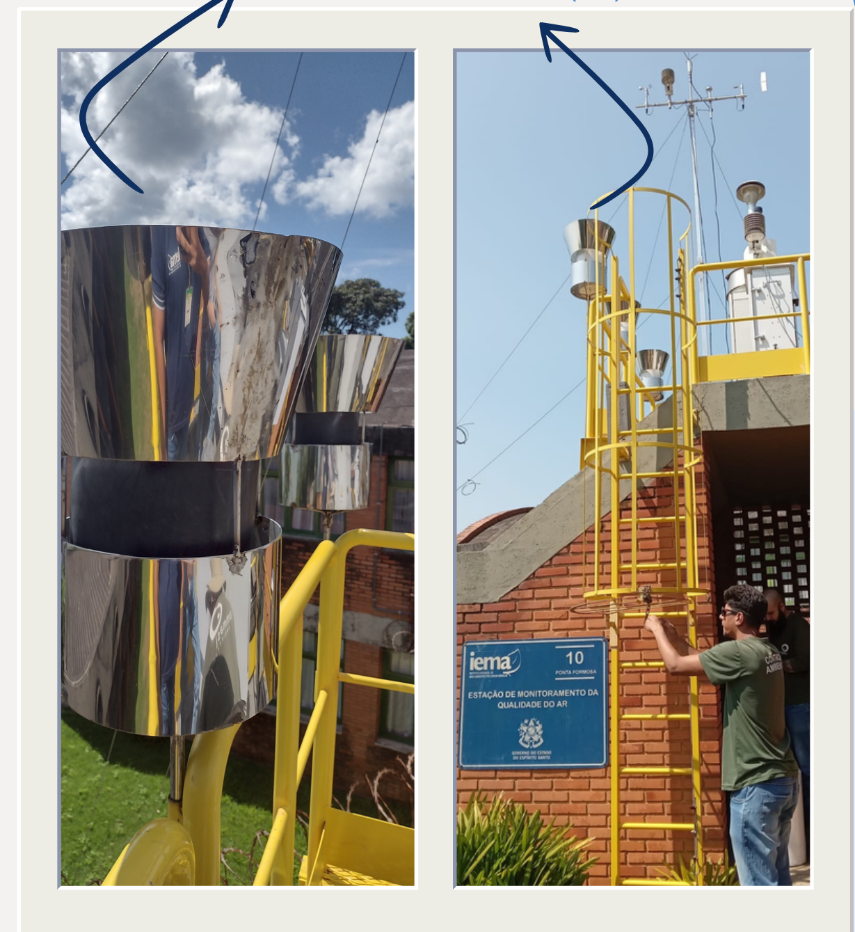
Recipiente coletor de Partícula Sedimentável (PS)
