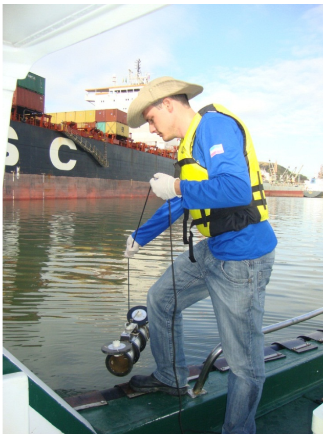
Figura 6-9: Exemplo de coleta de água com garrafa de van Dorn.
