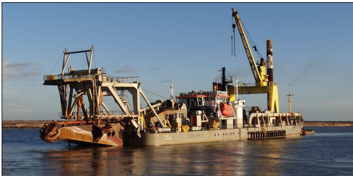
Figura 5-17. Exemplo de draga de sucção e recalque em operação.
