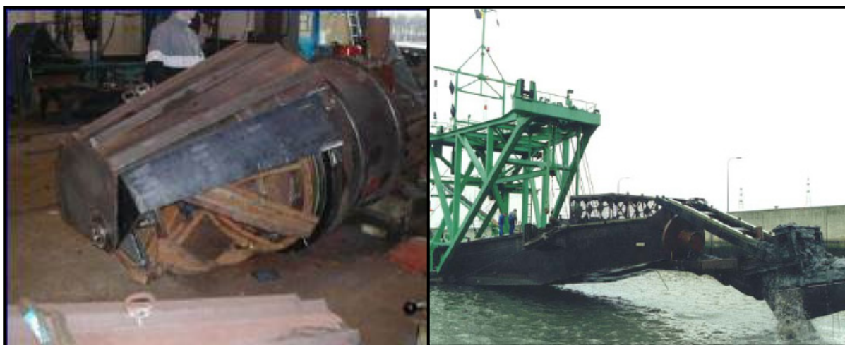
Figura 5-20. Detalhe da Draga de Sucção e Recalque com dispositivo scoop dredge .
