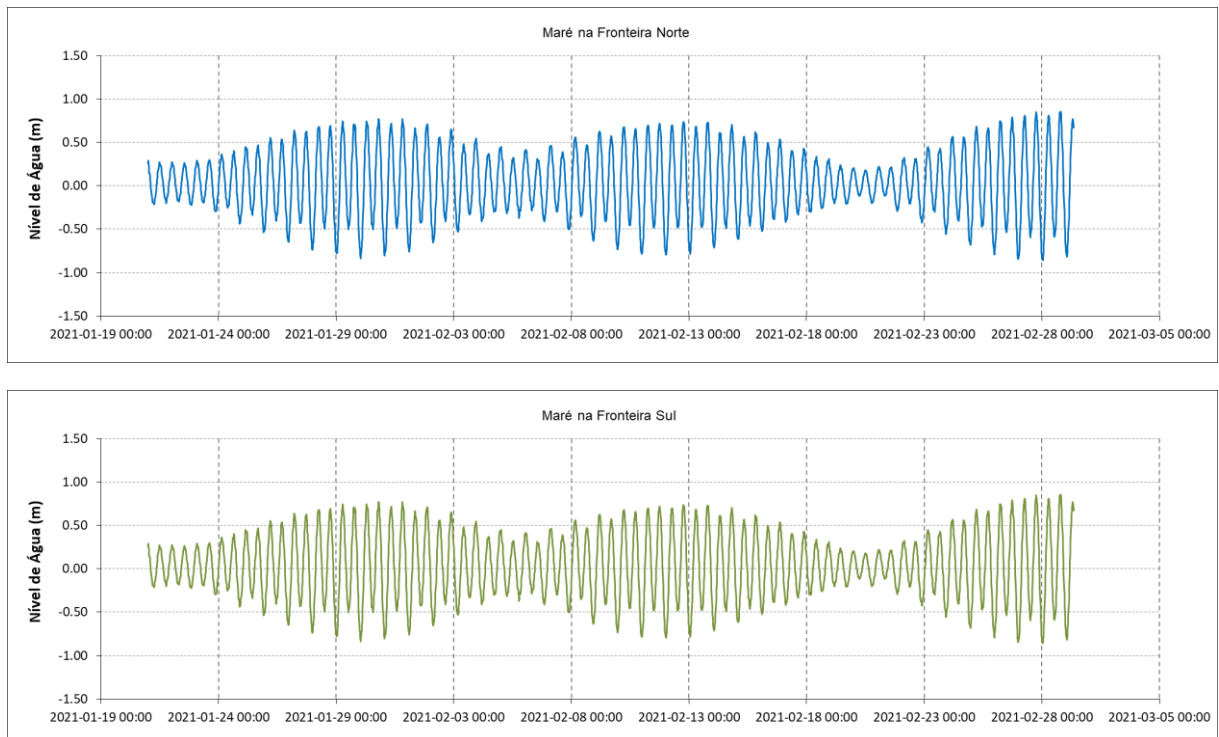
Figura A.5-2 Variação do nível de água devido às marés nas fronteiras norte e sul do modelo hidrodinâmico.
