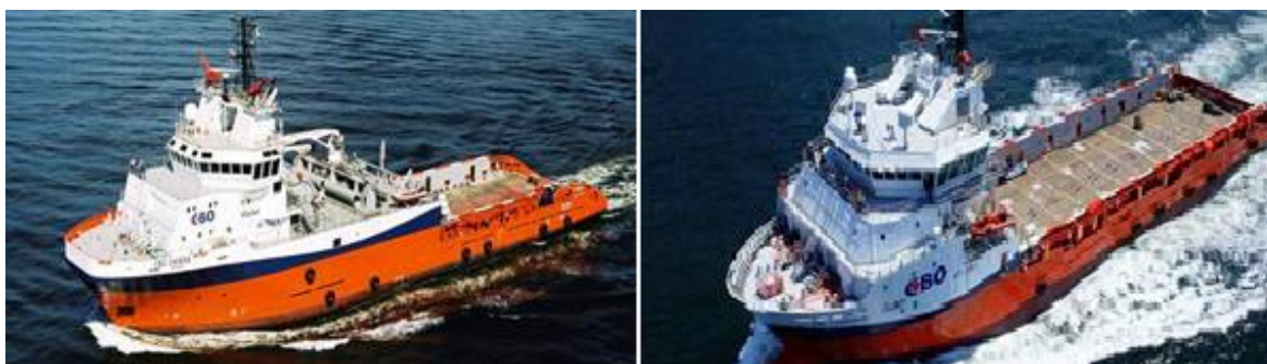
Figura 2-25: Exemplos de embarcações do tipo supply que irão atracar nos berços da Itaoca Offshore. A primeira é um AHTS ( Anchor Handling and Tug Supply ) e a segunda é PSV ( Platform Supply Vessel ).
