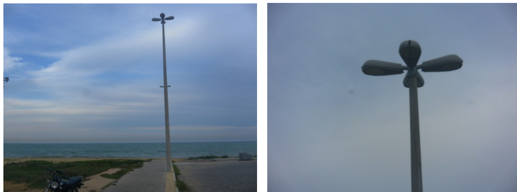
Figura 2-31: Sistema de iluminação formado por luminária tipo pétala com refrator prismático, com detalhe da luminária.
