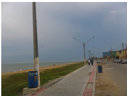
Figura 2-46: Área litorânea em zona urbana contemplada por iluminação pública voltada tanto para a via pavimentada urbana quanto para a praia, porém com luz do tipo vapor de sódio, com tonalidades na ordem do branco-azulado (6000 K).
