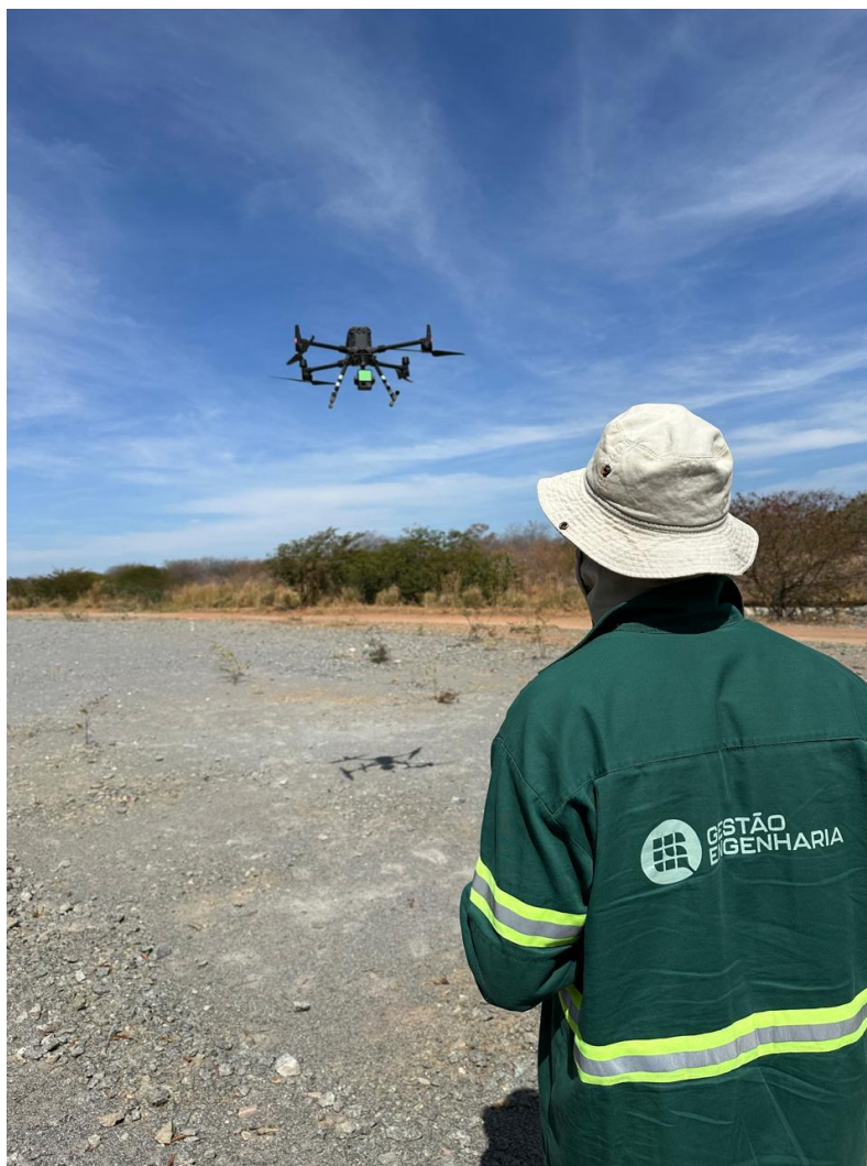
Figura 2. Drone Matrice 300 com o Laser Scanner DJI Zenmuse L2 acoplado.
