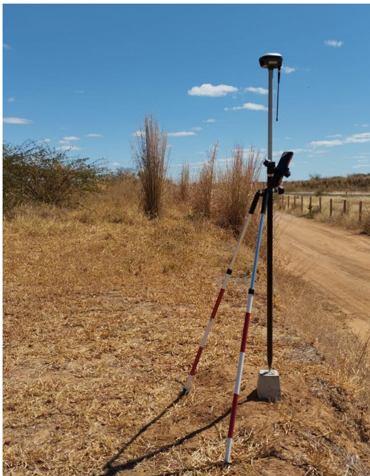
Figura 4. Receptor GNSS i73+ rastreando o marco topográfico.
