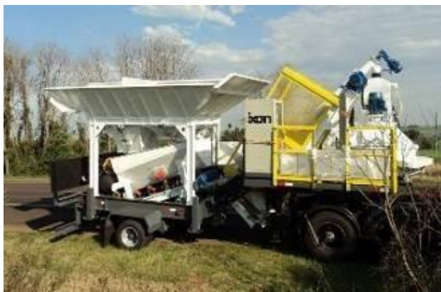
Figura 15: Exemplo da Usina de Concreto Móvel.
