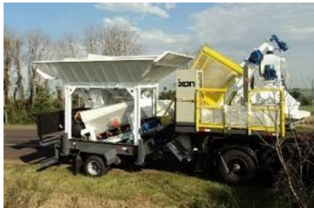
Figura 15: Exemplo da Usina de Concreto Móvel.
