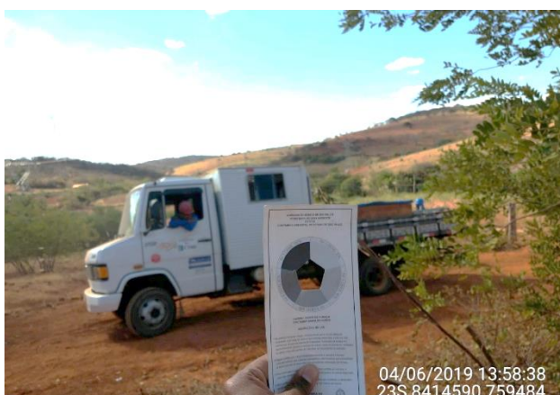
Foto 1-7: Monitoramento de fumaça preta (escala de Ringelmann). Fonte: Acervo Dossel, 2019.
