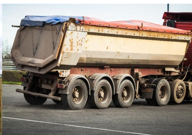
Foto 1-4: Exemplo de caminhão basculante com cobertura por lona, para transporte de agregados.
