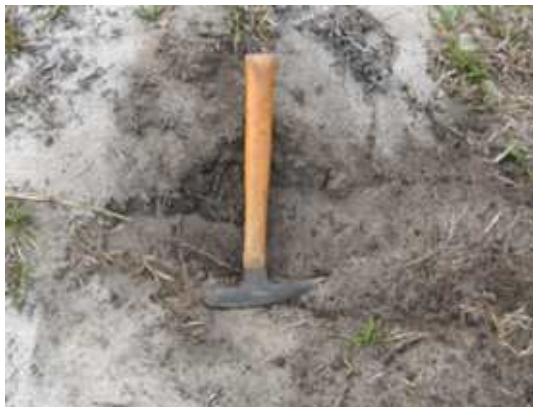
Detalhe dos aspectos texturais e mineralógicos das areias quartzosas marinhas presente na faixa da futura adutora. Nota-se a presença considerável de minerais pesados de coloração escura
