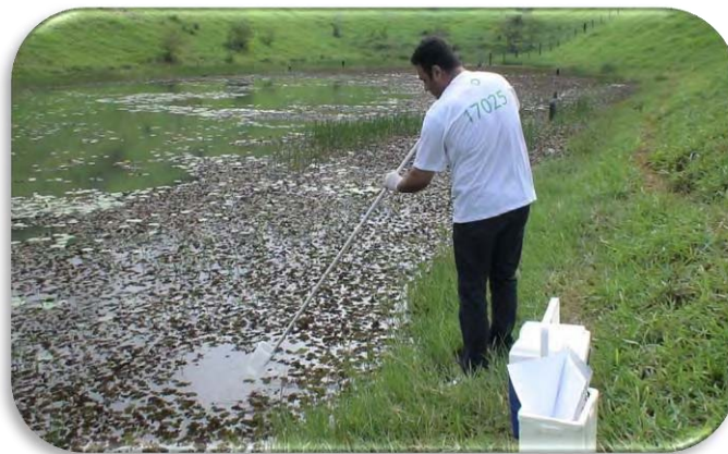
Figura 14 - Coleta de amostras de água da lagoa existente na área adjacente a UTE
