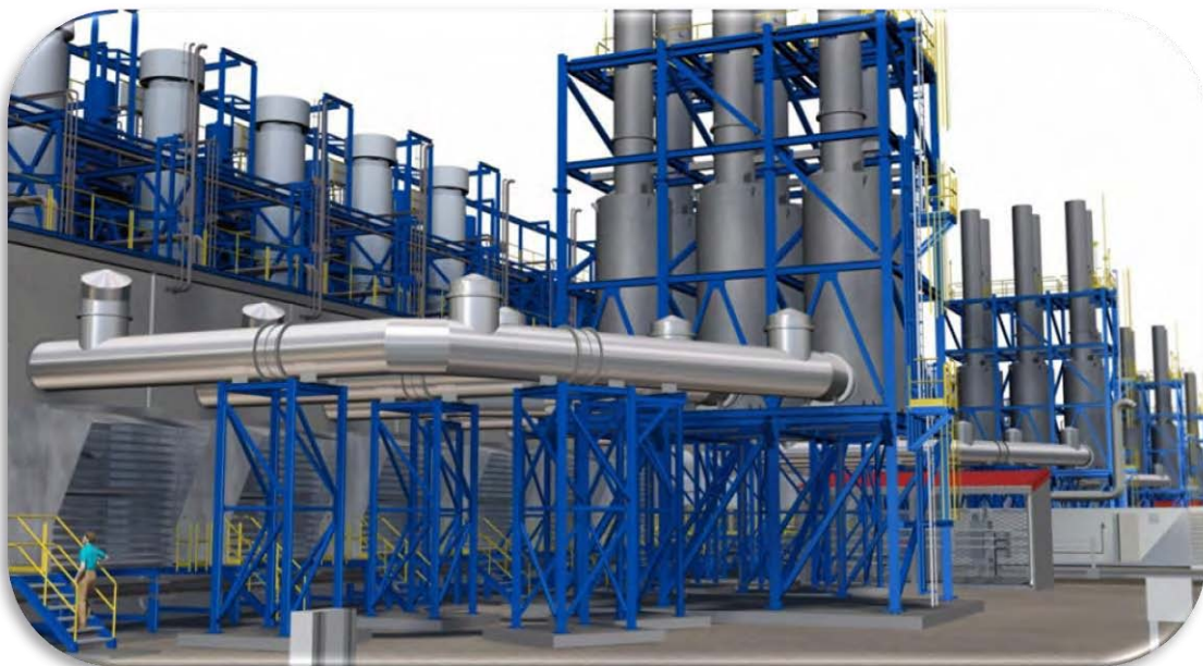
Figura 7 – Vista típica do sistema de exaustão de gases Fonte: WÄRTSILÄ
