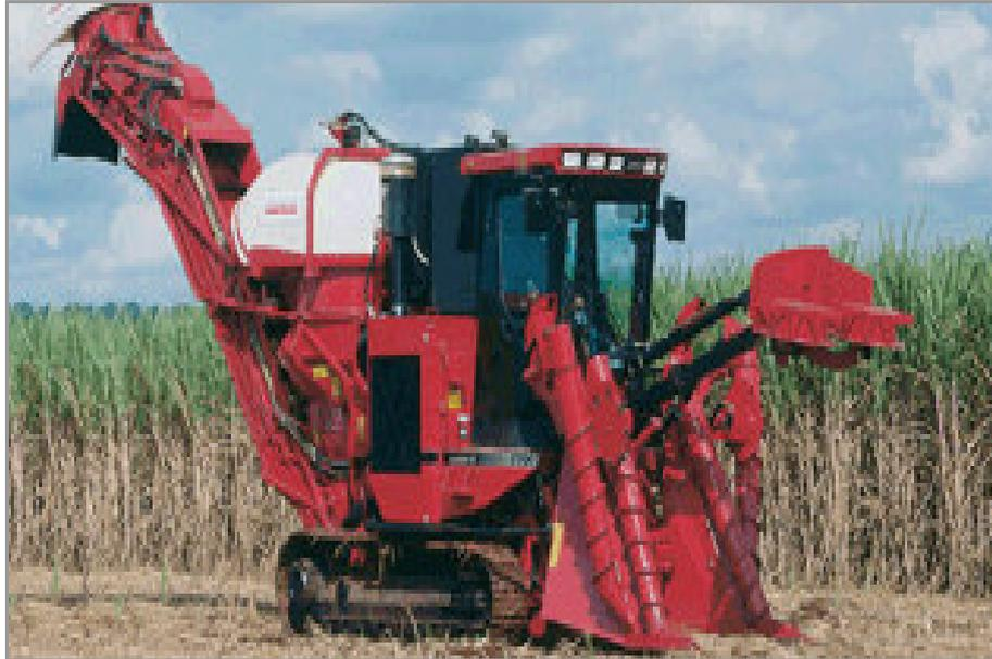
**Figura 6.1.2.1.1-6 – Ilustração colhedeira CASE modelo 7700, potência de 335 CV (246 KW), tipo de rodado esteira e altura do despontador 3600 mm**
