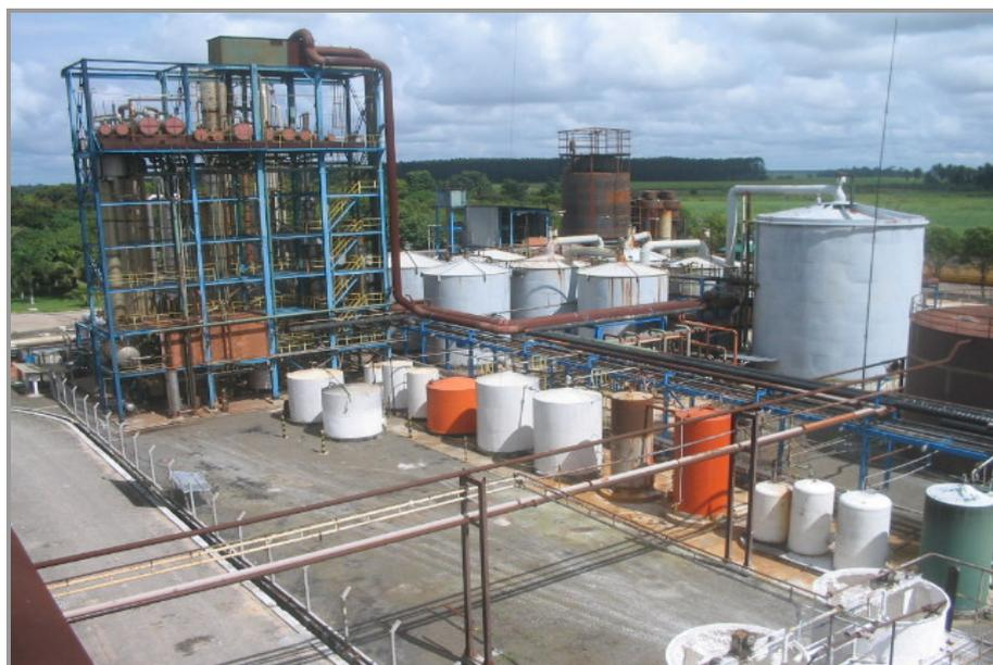
**Figura 4.6.2.1-7 – Sistema de destilação**
