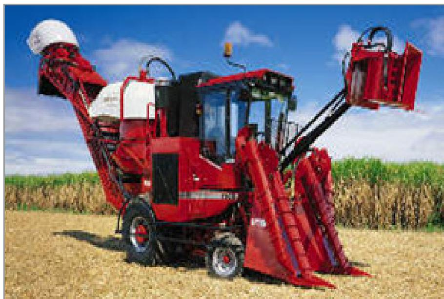
**Figura 6.1.2.1.1-5 – Ilustração colhedeira CASE modelo 7000, potência de 335 CV (246 KW), tipo de rodado pneus e altura do despontador 3600 mm**
