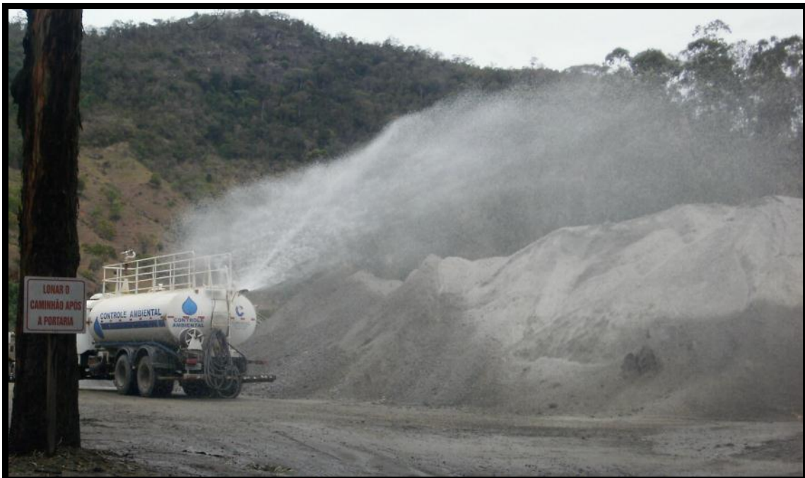
Fotos: Aspersão de água nas vias de acesso internos da mina
