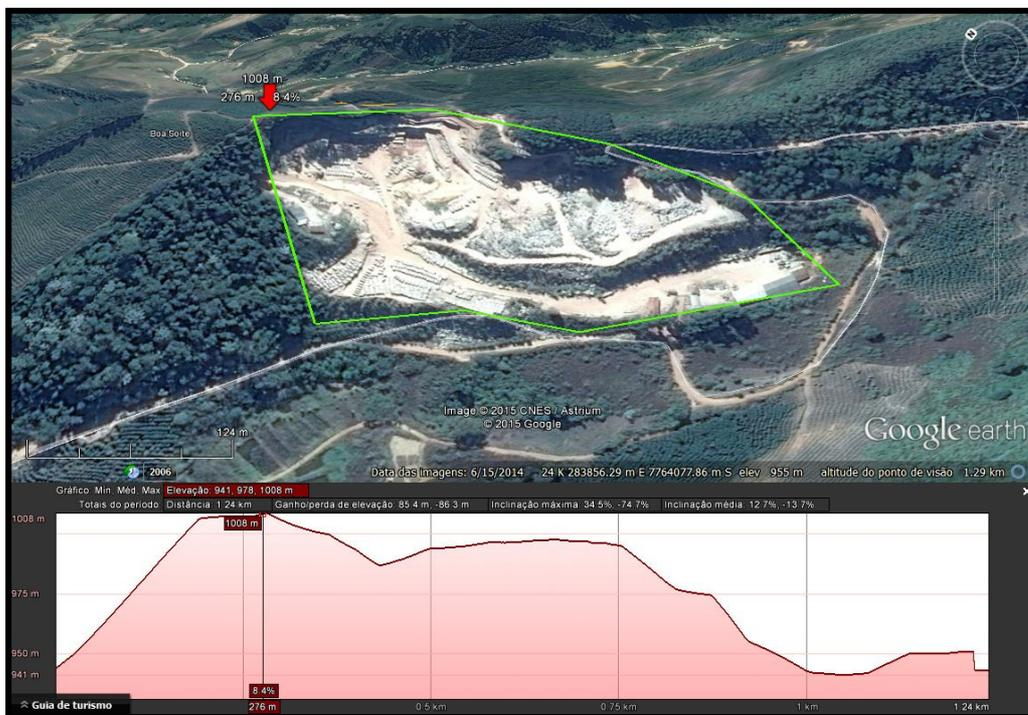
*Perfil de máxima elevação do solo no interior da área de intervenção (elevação máxima 1008 m). Fonte: Google Earth.*
