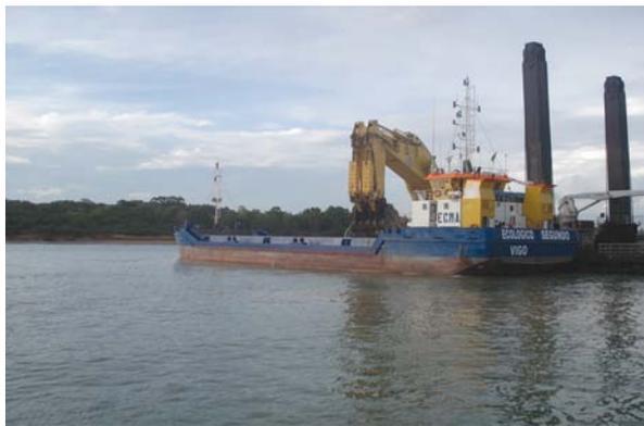
Figura 3-7: Modelo de Draga Escavadeira em operação e de um batelão.
