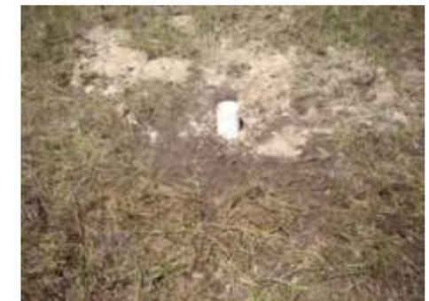
Poço provisório instalado na área do empreendimento para coleta de água para caracterização de sua qualidade.
