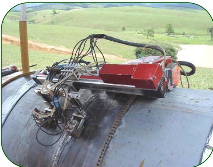
Inspeção da solda dos dutos feita por aparelho de ultrassom.
