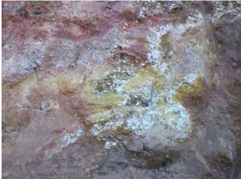
**FOTO 19 – Aspecto do solo de alteração das rochas granito-gnáissicas, em corte alto próximo do km. 9,6.**
