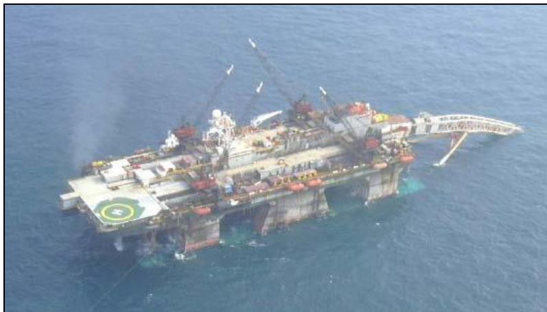
**Figura 3-17: Embarcação de lançamento Acergy Piper.** Fonte: Petrobras.
