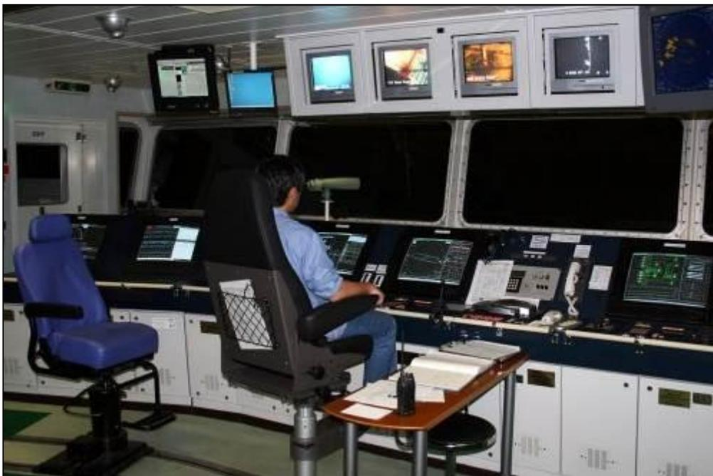
Figura 3-21: Painel de Controle do Sistema de Posicionamento Dinâmico.
