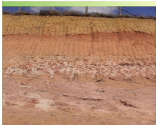
Figura 4: Corte de estrada apresentando perfil característico de ocorrência dos sedimentos na região.
