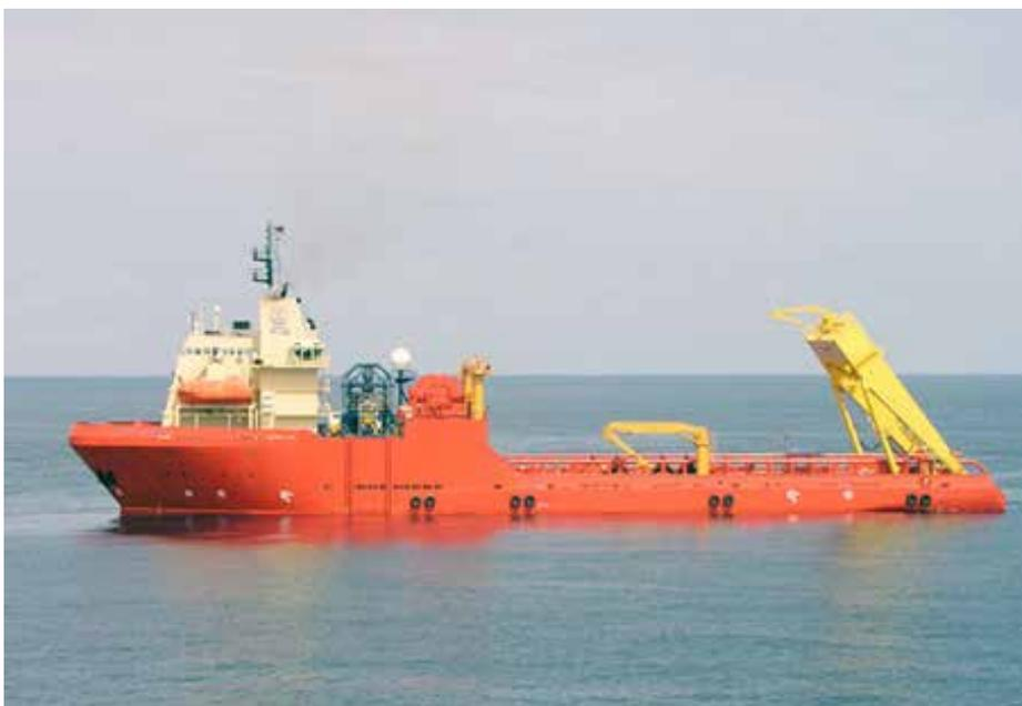
Embarcação do tipo *Anchor Handling Towing Supply Vessels*. Fonte: Chouest.
