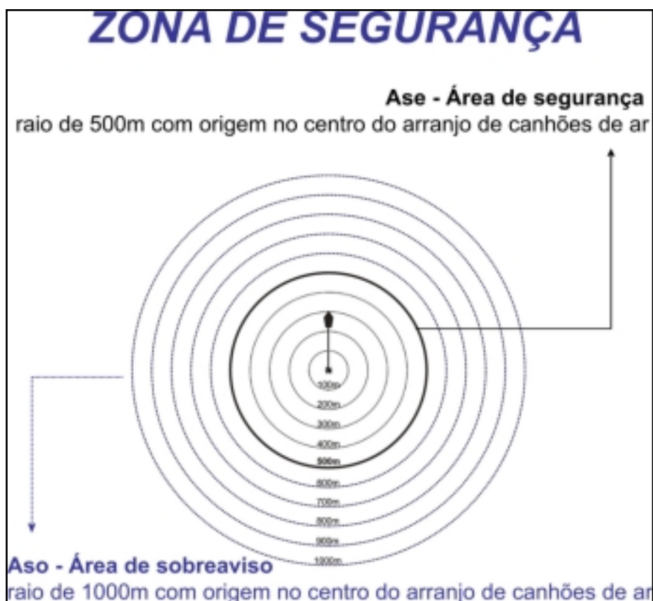
Figura 66 - Esquema das Áreas de Segurança (500m) e Sobreaviso (1000m)
