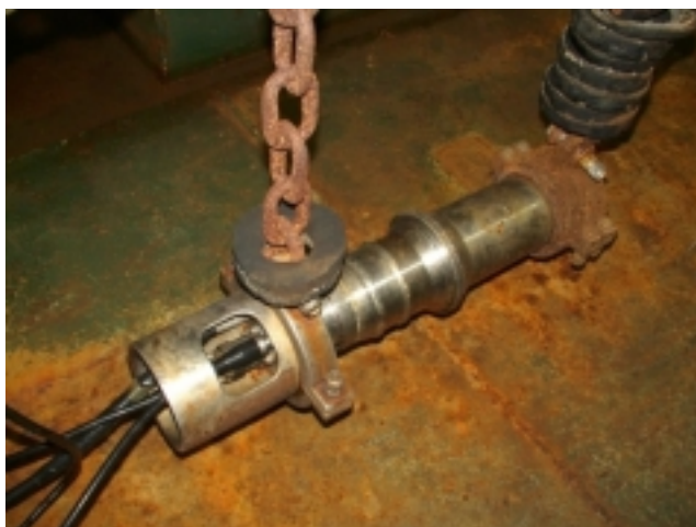
Figura 5 - Fonte de energia sísmica utilizada pelo navio sísmico Discoverer
