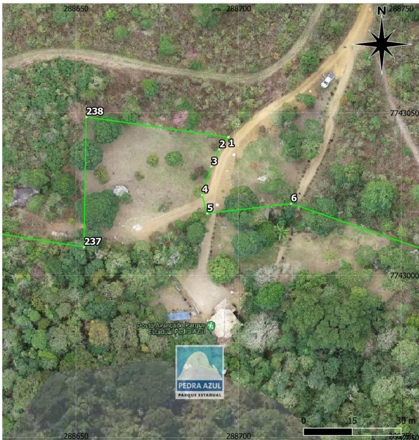
Fig.6: detalhe do Ortofotomosaico de alta resolução e pontos do memorial descritivo do perímetro do PEPAZ.
