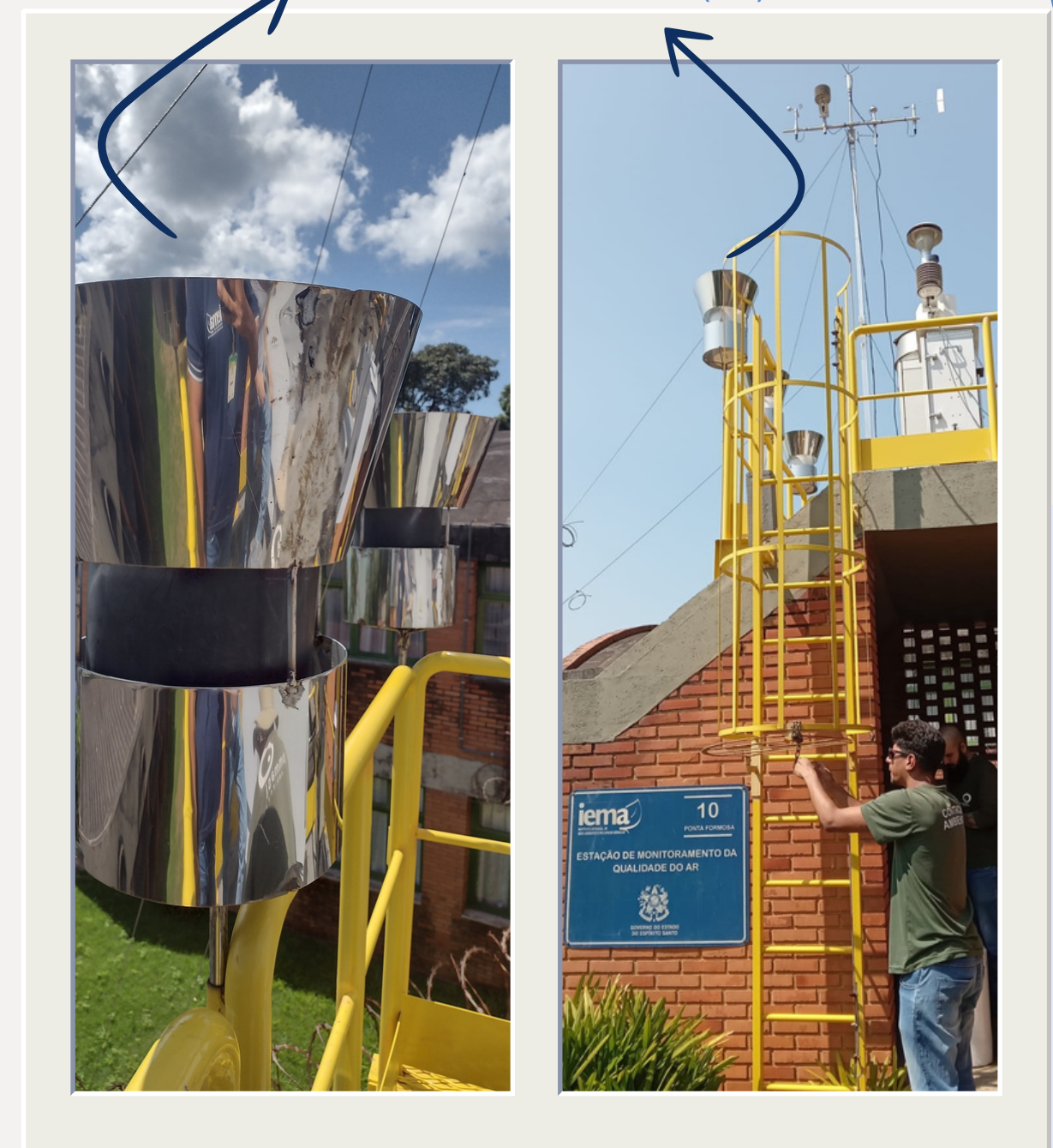
Recipiente coletor de Partícula Sedimentável (PS)
